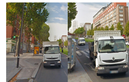
▲ Paris 13 e , boulevard Masséna : la piste cyclable sur trottoir se transforme en piste sur chaussée puis en bande, ramenant les vélos dans l'angle mort du camion avec une covisibilité médiocre ne permettant pas de bien anticiper le danger. (Google Street View)
