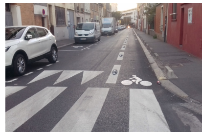
▲ Montreuil, rue Michelet : la protection du contre sens par des modules plastiques est mal vécue par les cyclistes dans le sens général, pressés par des automobilistes qui n'osent plus dépasser. Certains vélos en arrivent à rouler dans la bande à contresens. Moins de trafic, et donc un moindre besoin de protection, serait la réponse adaptée. (Paris en Selle)
