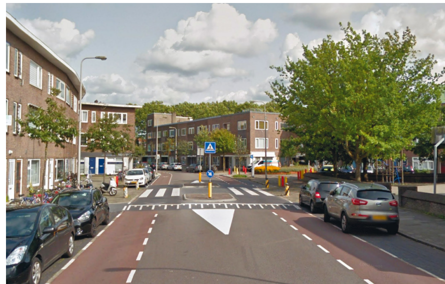
▲ Utrecht (Pays-Bas), Laan van Nieuw Guinea : les Pays-Bas posent les meilleures pratiques mais on y trouve aussi parfois de grosses erreurs, même dans des aménagements récents : ici, des bandes cyclables un peu étroites dans la zone d'ouverture des portières et un refuge piéton qui favorise les rabattements motorisés. (Google Street View)
