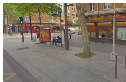
▲ Paris 14e, boulevard Brune : éviter : la piste fait office de quai bus. C'est une configuration qu'on trouve au Danemark pour conserver la continuité de la piste dans des situations contraintes. Les vélos doivent patienter quand les passagers débarquent et embarquent. Plus accidentogène, son bon fonctionnement repose sur l'hypothèse d'un respect systématique des usagers plutôt que sur l'aménagement. (Paris en Selle)
