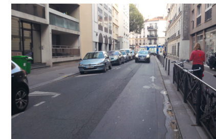
▲ Paris 13 e , rue de la Colonie : la chaussée hors stationnement mesure 3,50 m. Les vélos à contresens croisent les véhicules motorisés sans frôler de véhicules stationnés, mais ils sont contraints de rouler dans le caniveau au ras des barrières ou des potelets. (Paris en Selle)
