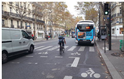
▲ Paris 4 e , boulevard Henri IV : la bande s'interrompt au niveau de l'arrêt de bus, obligeant les vélos à attendre derrière le bus ou à s'insérer dans la circulation générale. (Paris en Selle)
