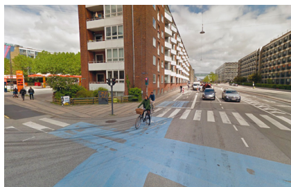
▲ Copenhague (Danemark), Tagensvej : la procédure standard pour tourner à gauche au Danemark consiste à faire un crochet à droite puis d'attendre le vert perpendiculaire. (Google Street View)
