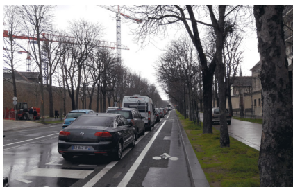
▲ Paris 13 e , boulevard Arago : la peinture permet de maximiser la largeur de la piste, mais les dimensions sont sous-calibrées : la piste est trop étroite (1,50 m avec le caniveau en asphalte) et les voitures sont à l'étroit sur leur emplacement (1,80 m) et tendent à déborder sur l'espace tampon (0,70 m). (Paris en Selle)
