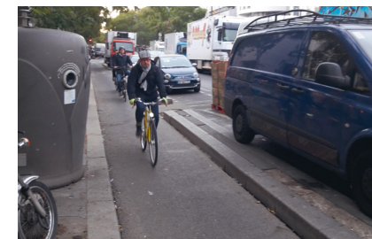
▲ Paris 20 e , boulevard de Belleville : la piste de 1,60 m de large (même sans caniveau) force à rouler à la queue leu leu sans pouvoir doubler ou circuler à deux de front. (Paris en Selle)
