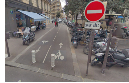
▲ Paris 9°, rue de Provence : les potelets en métal (encore visibles au fond) ont été remplacés par des plots en plastique, moins dangereux en cas de collision d'un vélo, mais placés en plein sur leur trajectoire. (Google Street View)
