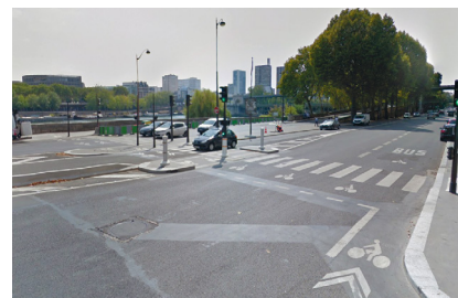
▲ Paris 16 e , avenue de New-York : la traversée de chaussée en direction de la voie Georges Pompidou se fait de façon totalement inadaptée via un sas vélo : inutilisable au vert (sans espace de stockage pour attendre) et peu respecté par les motorisés au rouge, ce qui pousse les vélos à passer par le passage piéton. (Google Street View)
