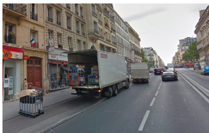
▲ Paris 10 e , rue La Fayette : la piste est implantée à la danoise à mi-niveau avec une hauteur de 14 cm qui s'abaisse au droit des entrées d'immeubles. Ces bateaux non protégés par des potelets exposent la piste au stationnement sauvage. (Google Street View)
