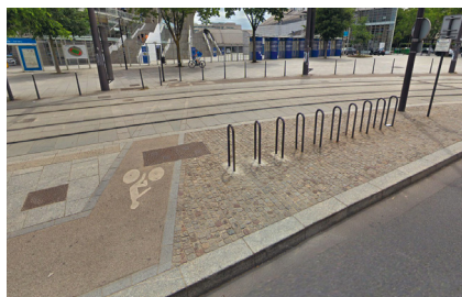
▲ Paris 13 e , boulevard Kellermann : le franchissement des rails se fait avec des angles quasi droits incompatibles avec la physique d'un vélo. Tous les vélos coupent les rails en amont du chemin dessiné par l'aménageur. (Google Street View)
