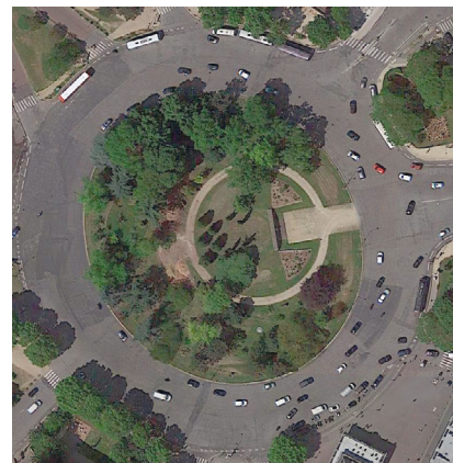
▲ Paris 16 e , place du Maréchal de Lattre de Tassigny (Porte Dauphine) : un rond-point sans feux avec priorité à droite et de multiples files, ceinturé par une bande cyclable. Un véritable hachoir à vélos qui oblige à des détours gigantesques. L'extension du tram T3 permettra la mise en place d'un anneau cyclable bidirectionnel, mais sans garantie d'équipement en feux pour l'instant. (Google Maps)
