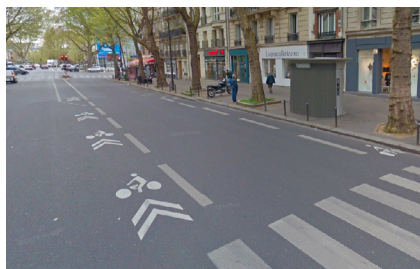
▲ Paris 5 e , boulevard Saint-Germain : les vélos rejoignant le pont de Sully doivent couper deux files de circulation pour rejoindre la bande de présélection étroite, coincée au milieu du trafic, et par ailleurs formidablement peu respectée aux heures de pointe. (Google Street View)
