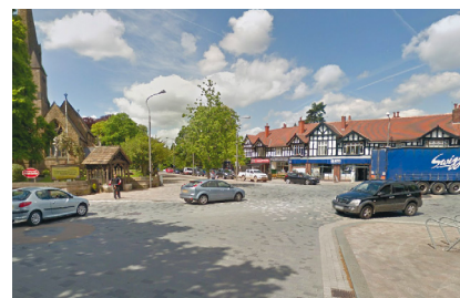
▲ Poynton (Royaume-Uni), Fountain Place : les pavés et les trottoirs abaissés de ce double-giratoire visent à ralentir le flux motorisé. Mais confronté à un trafic intense (26 000 véhicules/jour), le vélo à gauche de l'image préfère se réfugier sur le trottoir dans l'attente de pouvoir traverser. (Google Street View)
