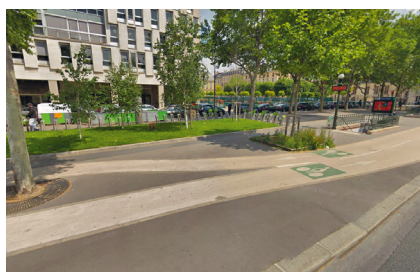
▲ Paris 4 e , quai de l'Hôtel-de-Ville : les girations de la piste sur trottoir pour contourner l'arbre sont très douces et permettent de garder une vitesse constante. (Google Street View)
