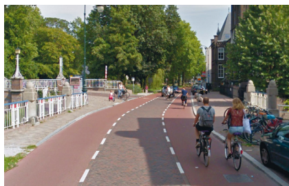
▲ Utrecht (Pays-Bas), Tolsteegsingel : la chaussée accueille deux bandes suggérées de 2,00 m et un espace central pavé de 2,50 m. La rue est à double sens pour les voitures (4 800 véhicules/jour contre 6 400 vélos/jour) et conserve une fonction de transit pour contourner le centre-ville. (Google Street View)
